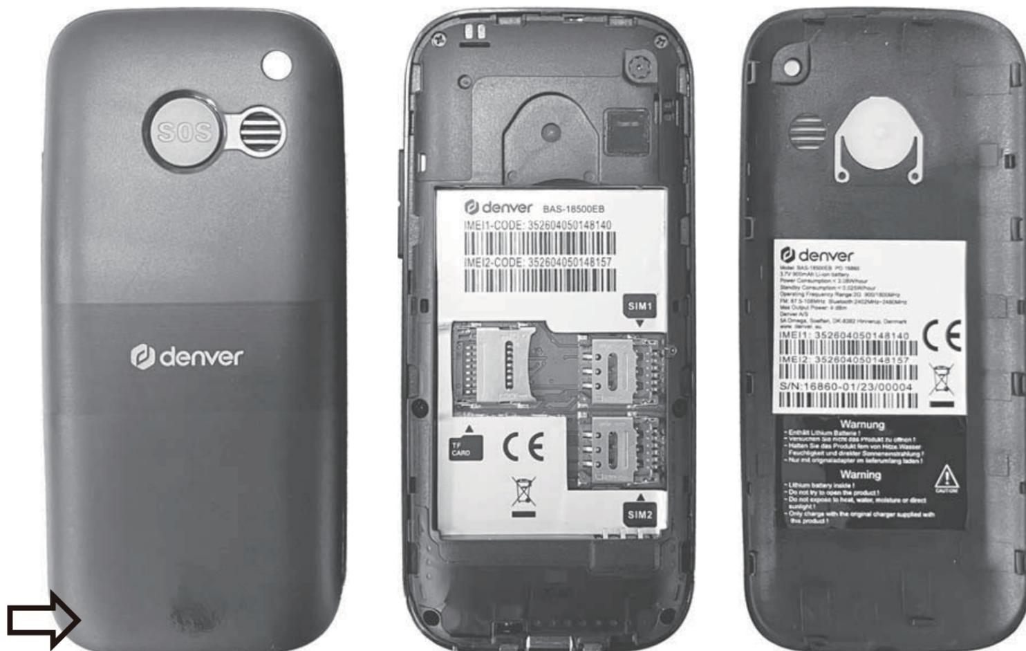
Setzen Sie die SIM-Karte(n) wie in der nachstehenden Abbildung gezeigt in den Halter ein, wobei der Chip nach unten zeigt. SIM-Karten sind nicht im Lieferumfang enthalten. SIM-Karten und Kontakte können leicht verkratzen und verbogen werden. Seien Sie entsprechend vorsichtig.
